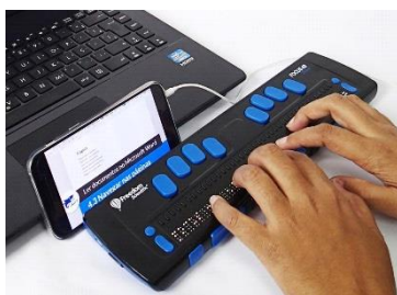
Figura 20 - a) Pessoa usando a linha braille plugada ao celular; b) Linha braille
