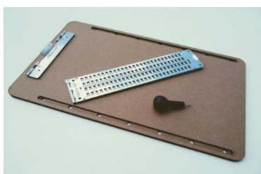
Figura 18 - Ferramentas de escrita braille; a) reglete negativa, prancheta e punção; b) reglete positiva de plástico e punção
